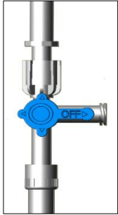
Figura 2. Ilustração do posicionamento da manopla da torneirinha para a insuflação de ar.
